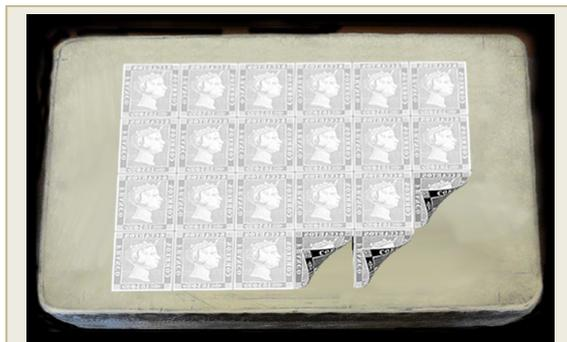
*Fig. 9. Colocación de los 24 reportes individuales para obtener la piedra del bloque reporte I.*
